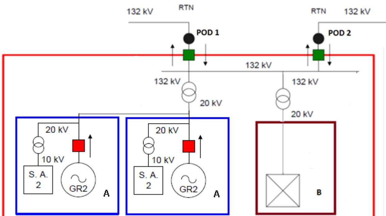
*Figura 4: Esempio di un sistema qualificabile come SEESEU-B costituito da due impianti di produzione, un'Unità di Consumo e con due punti di connessione alla rete pubblica*
