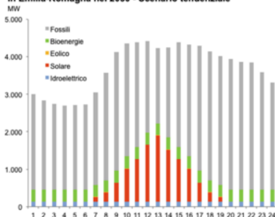
Potenza oraria richiesta relativa al consumo elettrico lordo in Emilia-Romagna nel 2030 - Scenario tendenziale
